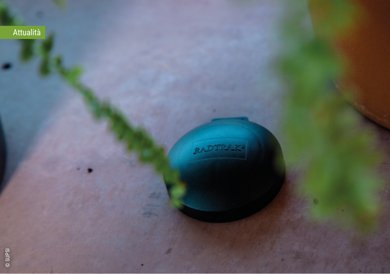
Strumento di dosimetria passiva per la misurazione delle concentrazioni di radon in un locale chiuso.
