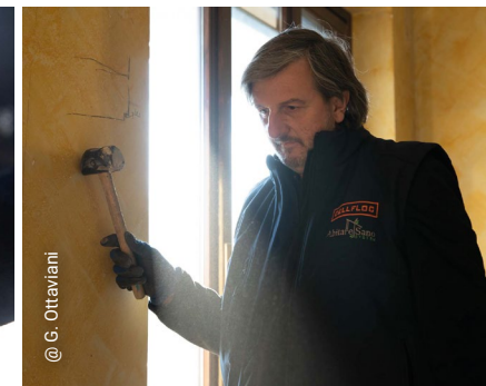
Diagnosi preliminare della parete con battitura e indagine endoscopica.
