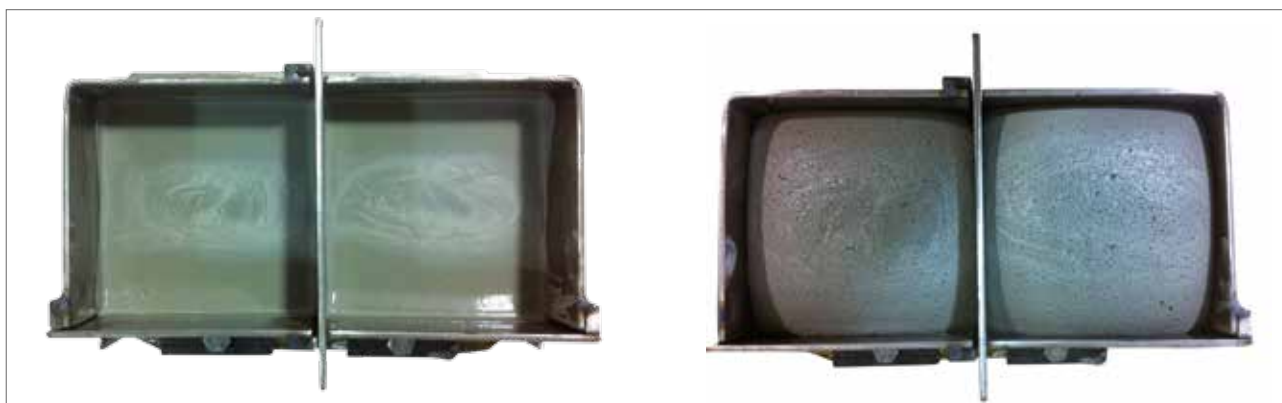
Fig. 1. Provini di BAAC prima e dopo la lievitazione bio-organica.
