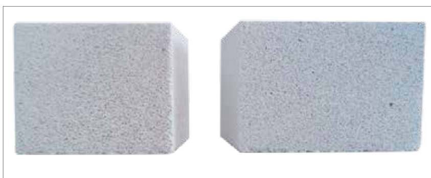
Fig. 2. Confronto tra un campione di BAAC (sx) e il corrispettivo prodotto commerciale di CAA (dx).
