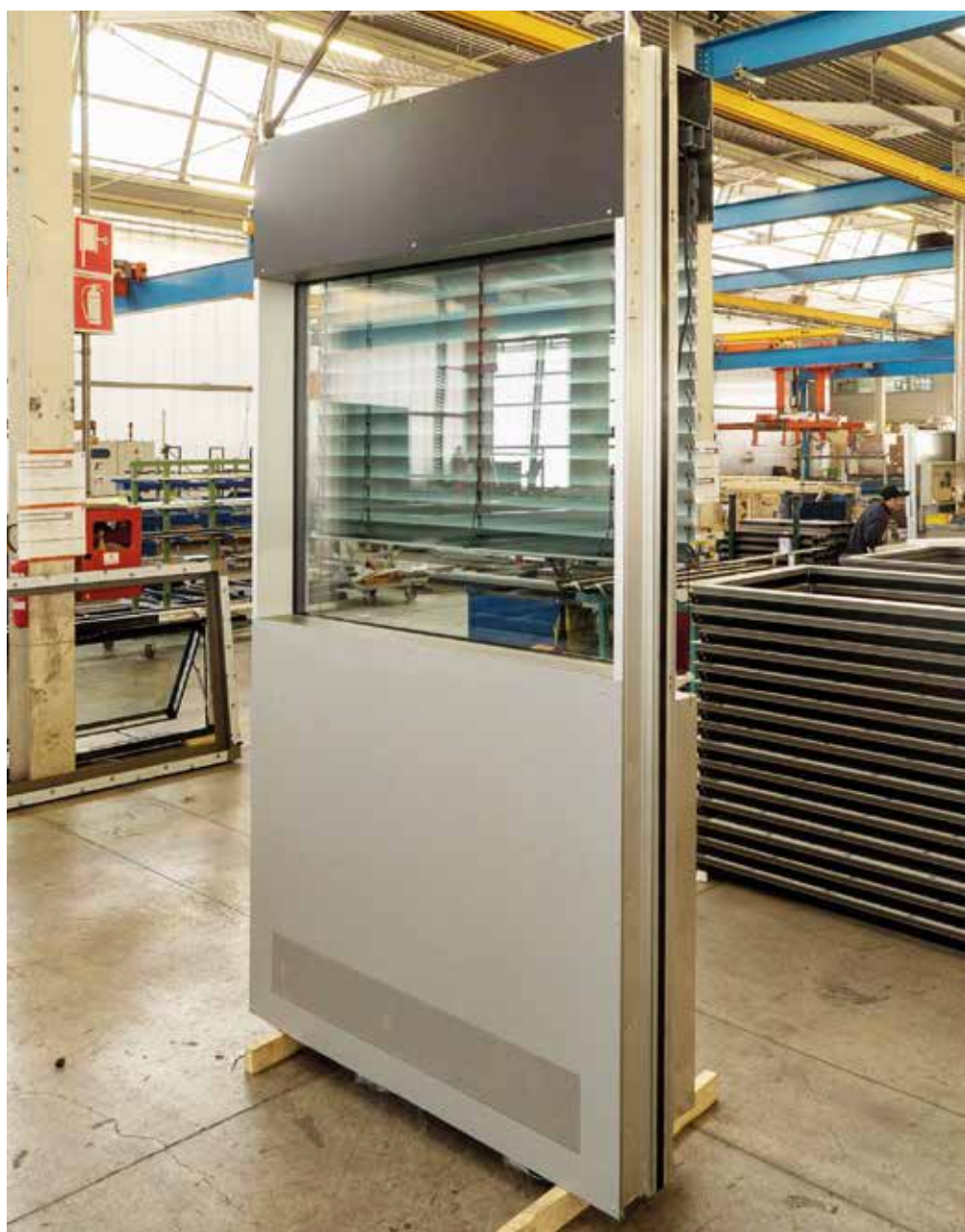
Figura 1: Vista del prototipo di facciata multifunzionale con integrato al suo interno una macchina di ventilazione meccanica decentralizzata.
