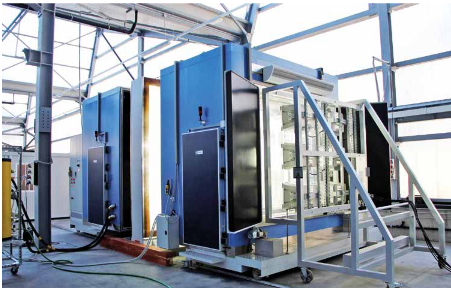
Figura 3: Camera climatica dell'Istituto per le Energie Rinnovabili di Eurac Research utilizzata per condurre i test sul modulo di facciata multifunzionale.
