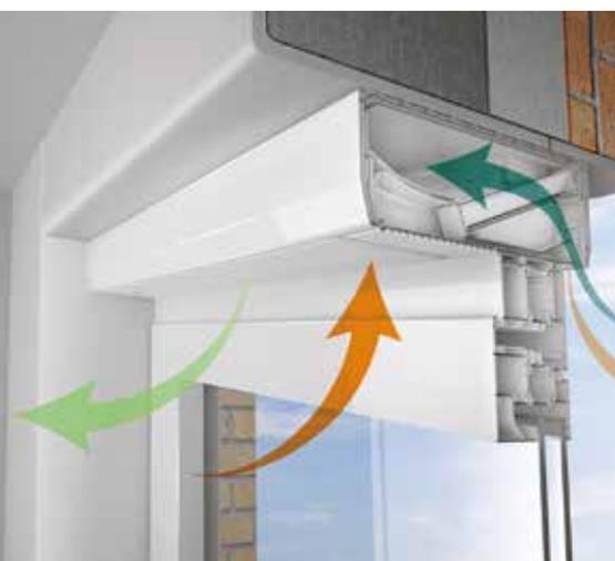
Schema di funzionamento della VMC integrata nella finestra - Fonte: Thesan
