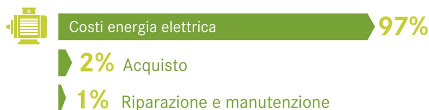
Fonte: Esempio motore IE3 Motor, 11 kW, 4.000 h, 15 anni (Almeida, et.al, 2008)
