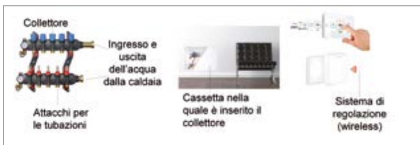
Figura 8. Sistema innovativo di regolazione del sistema radiante (Fonte: Eurotherm).
